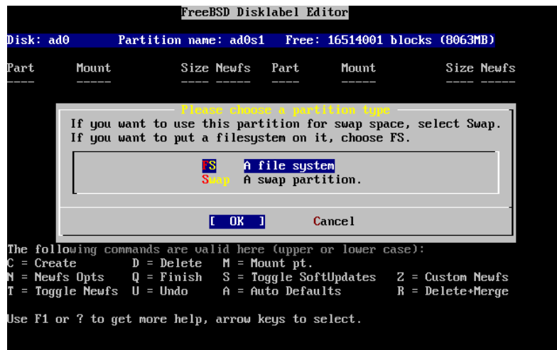
Figuur 2-22. Type van de rootpartitie kiezen
